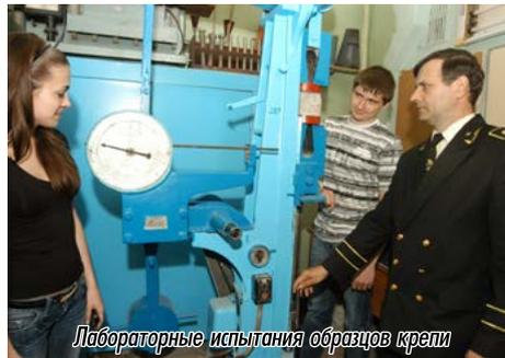
Лабораторные испытания образцов крепи
