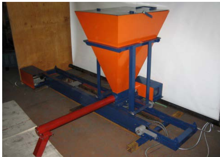
Физическая модель системы механизированной подачи шлакообразующей смеси в кристаллизатор МНЛЗ
