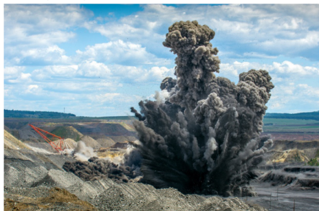
Взрывные работы при разработке карьера
