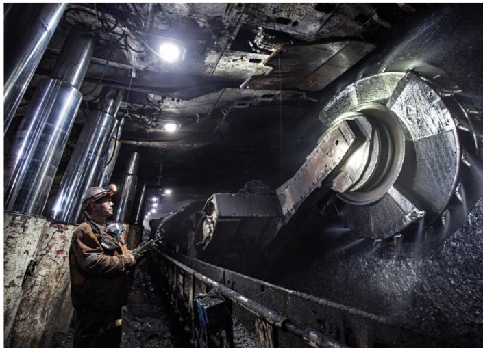
Добыча угля в лаве очистным комплексом
