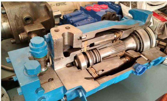
*Аксиально-плунжерный насос. Лаборатория гидропривода*
