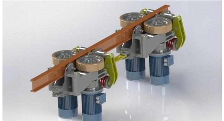
*Итог курсового проектирования – привод каретки монорельсовой дороги*
